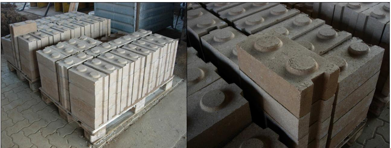
Trascorso questo tempo i BTC sono pronti per essere messi in opera con della semplice barbotina di terra. La terra argillosa fluida permette di unire le facce dei blocchi come delle ventose.
