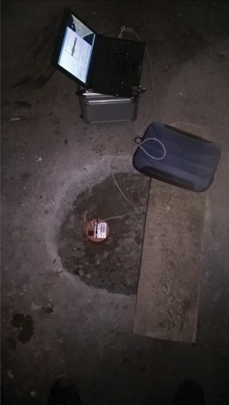
Prova simica HVSR – GEMINI 4 PASI geofono tridimensionale 4,5 Hz
