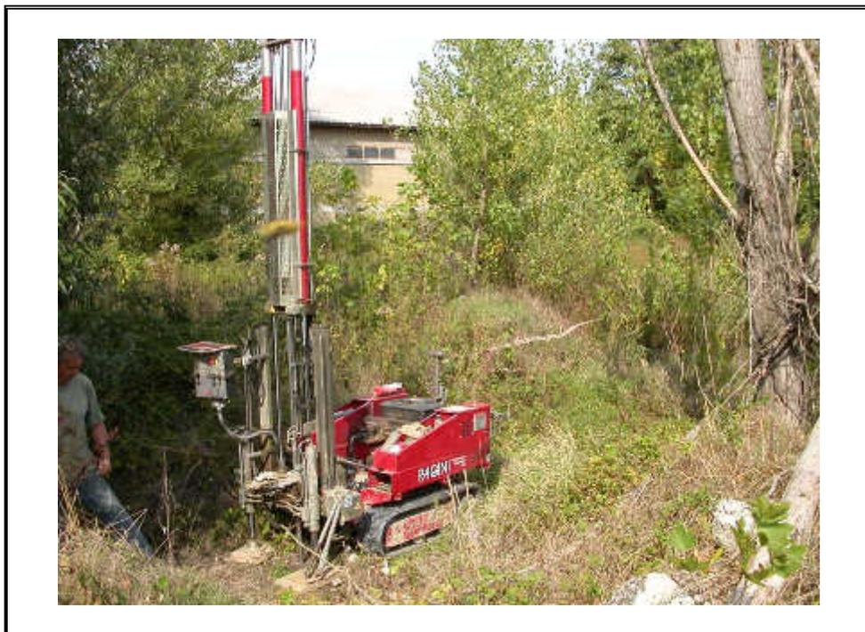
**Foto 20:** Posizionamento prova penetrometrica dinamica P2.
