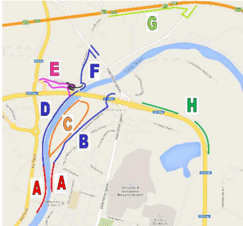
**A - Adeguamento in quota mediante rialzo del muro arginale in sponda destra (106 cm) e sinistra (62 cm).**
