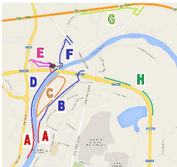
**A - Adeguamento in quota mediante rialzo del muro arginale in sponda destra (106 cm) e sinistra (82 cm).**
