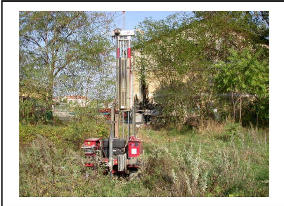
**Foto 21:** Posizionamento prova penetrometrica dinamica P3.
