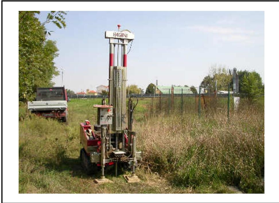
**Foto 19:** Posizionamento prova penetrometrica dinamica P1.
