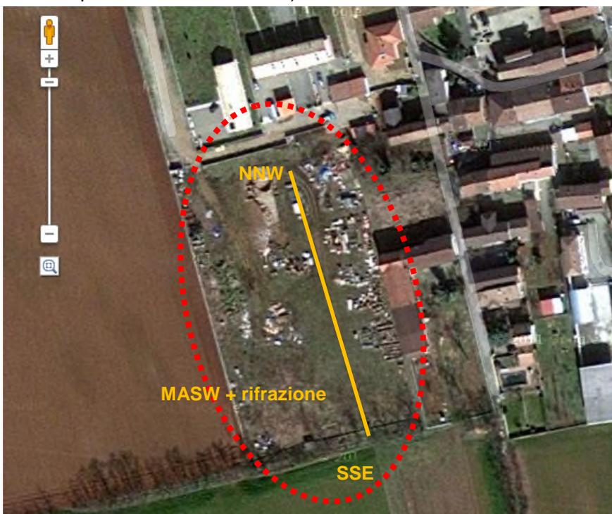
Fig. 12. Ripresa area del sito con individuazione dell'area di PEC (colore rosso) ed ubicazione schematica dello stendimento sismico (colore arancio).
