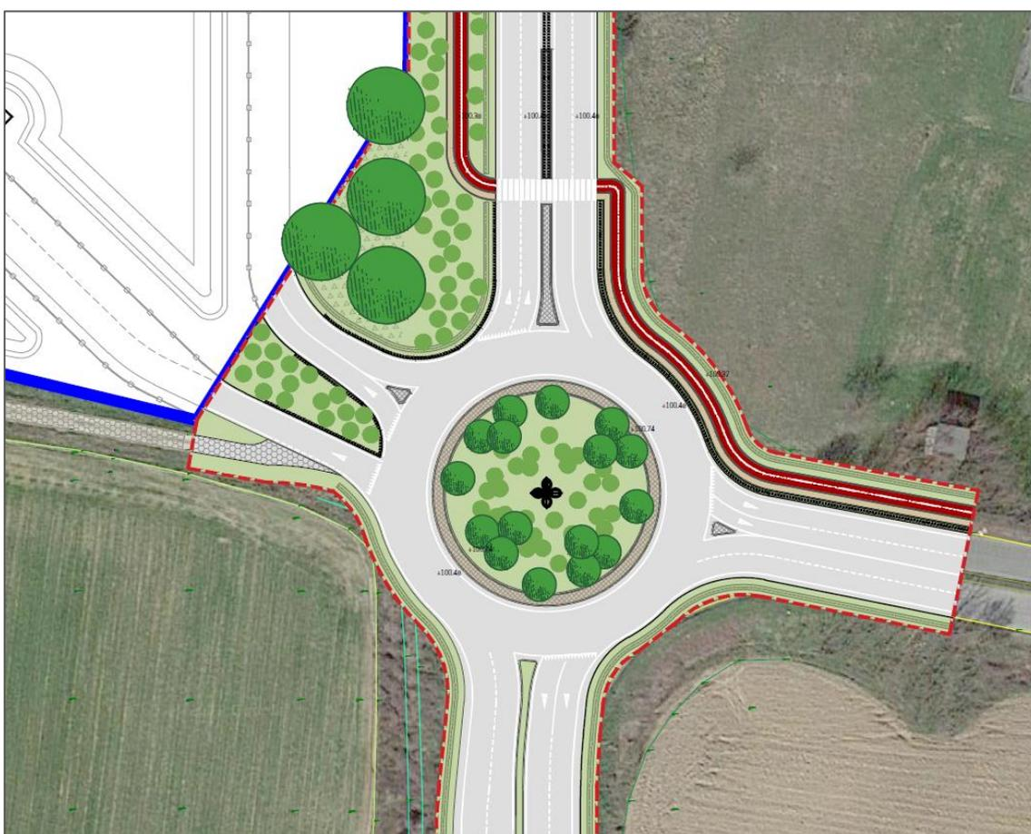
La rotonda presenta un anello di larghezza 9,50 m e una corona sormontabile in porfido di una larghezza di 2 m. La sede stradale ha una pendenza del 2.5% inclinata verso l'esterno della rotatoria, il sistema di raccolta delle reti meteoriche è il medesimo descritto al **punto 2.1.2** per le rotatorie R1 e R2. Al centro della rotonda è prevista una torre faro per l'illuminazione della viabilità.
