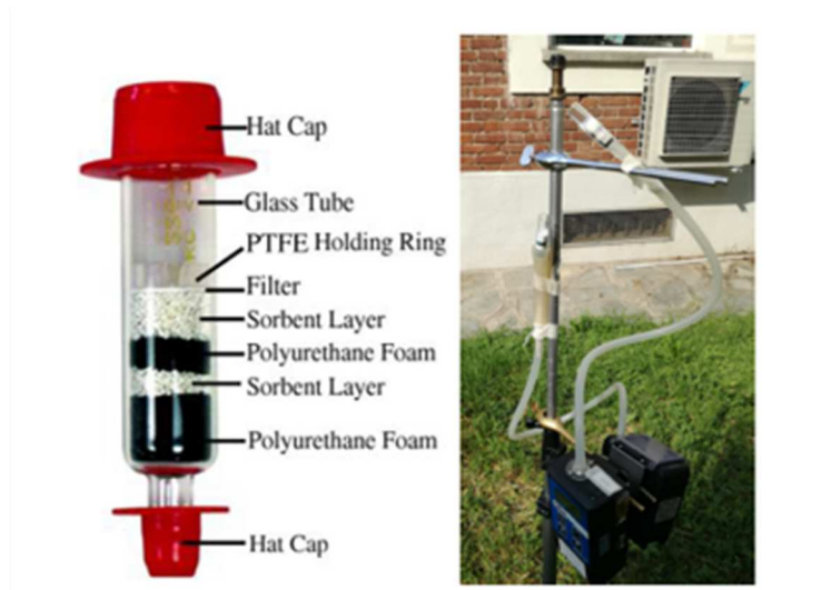
Figura 3-Fiala adsorbente: filtro in fibra di quarzo-XAD2
