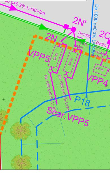
**NOTE: IMPIANTI DI PRIMA PIOGGIA IN CONTINUO** per scarico su suolo nel rispetto della tab. IV, all. 5 - L. 152/06 - parametri S.S.T e oli minerali e idrocarburi.
