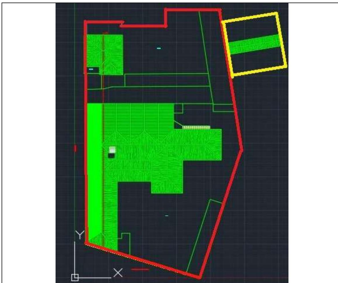
Area di intervento nella situazione ante operam: all'interno della perimetrazione in rosso i fabbricati saranno demoliti, il fabbricato all'interno della perimetrazione in giallo verrà ristrutturato e adeguato.
