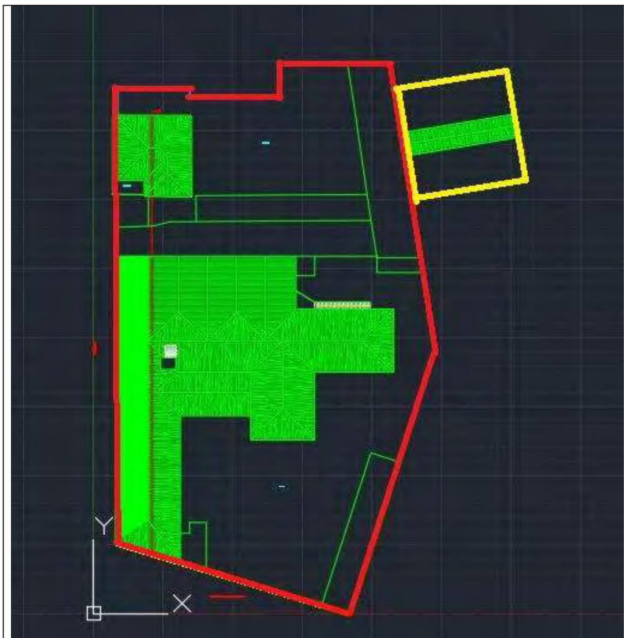
Area di intervento: all'interno della perimetrazione in rosso i fabbricati saranno demoliti, il fabbricato all'interno della perimetrazione in giallo verrà ristrutturato ed adeguato.
