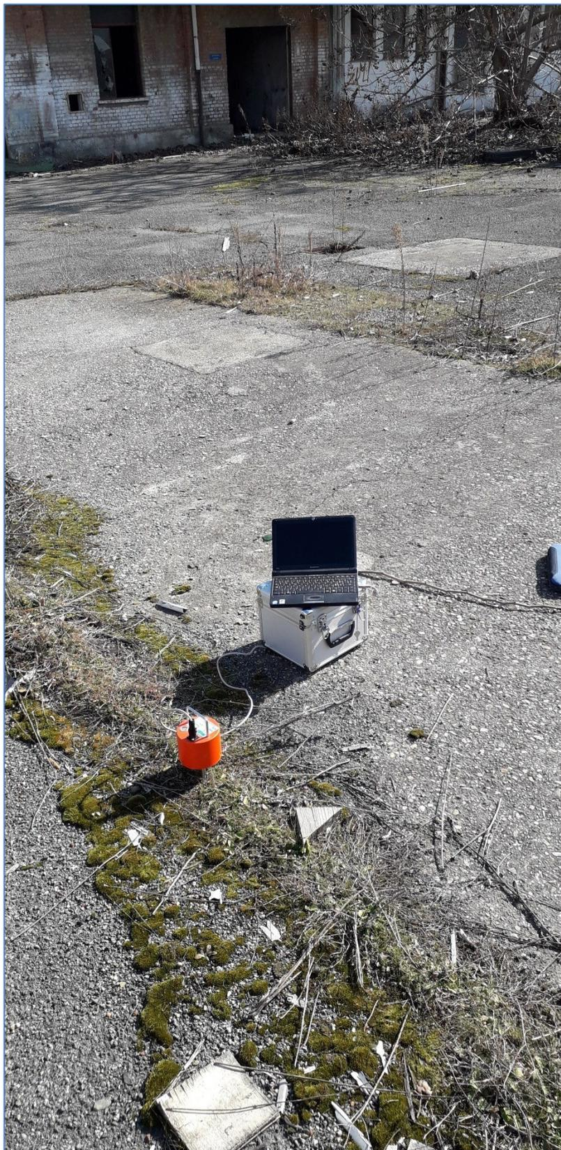
PROVA SISMICA HVS
