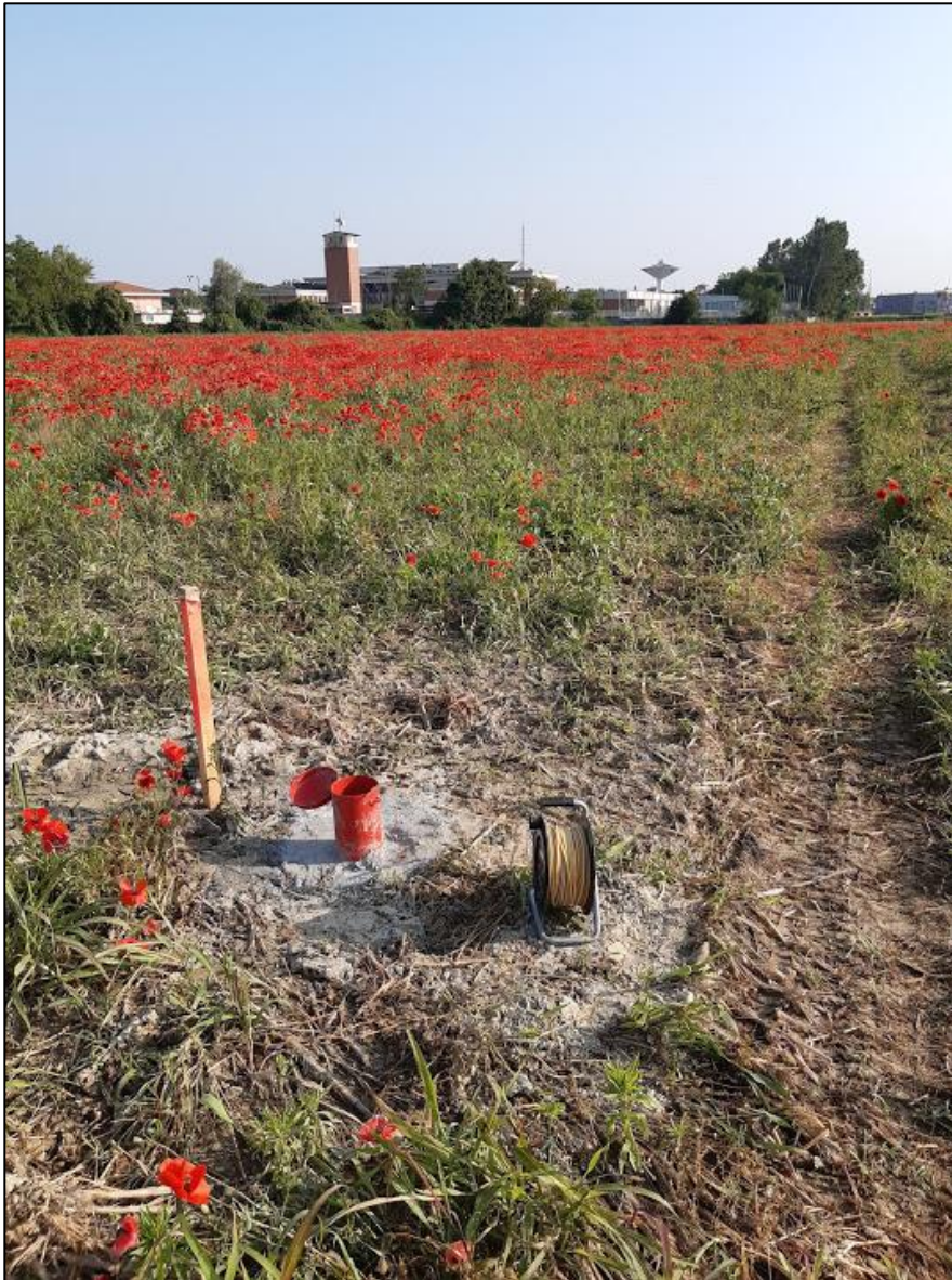
Misura freaticometrica piezometro carotaggio S02
