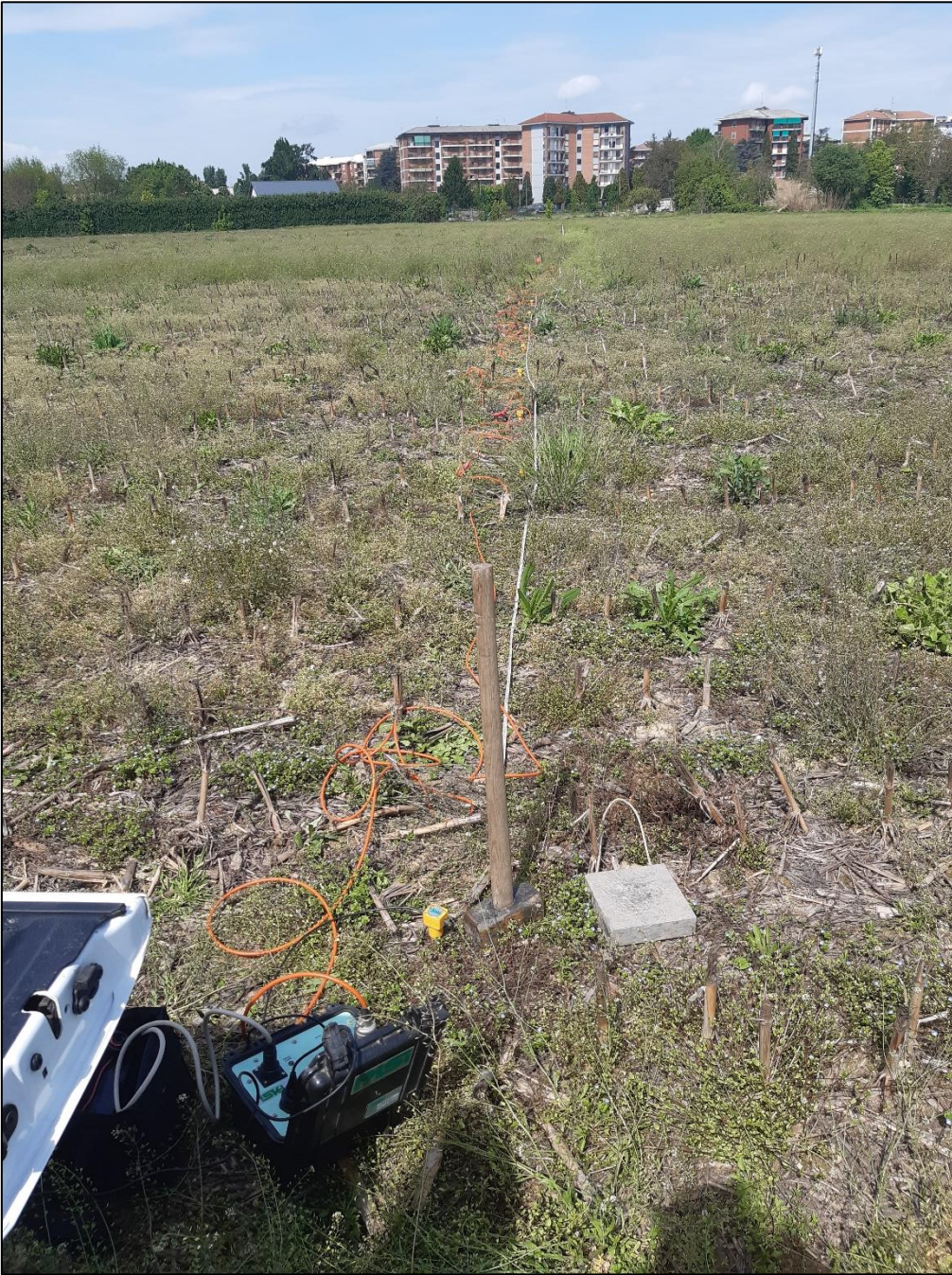
Stendimento prova sismica MASW 2
