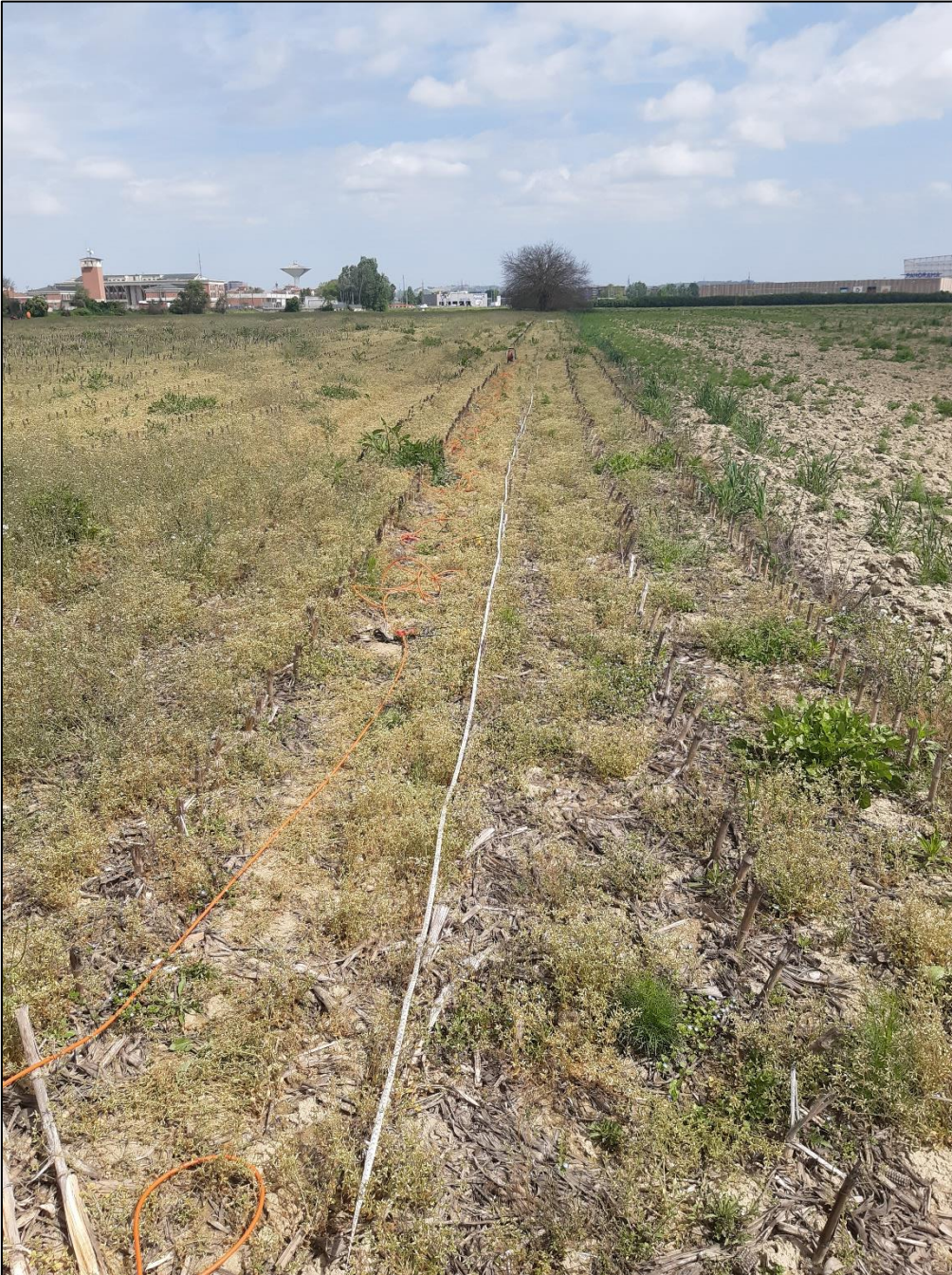
Stendimento prova sismica MASW 1
