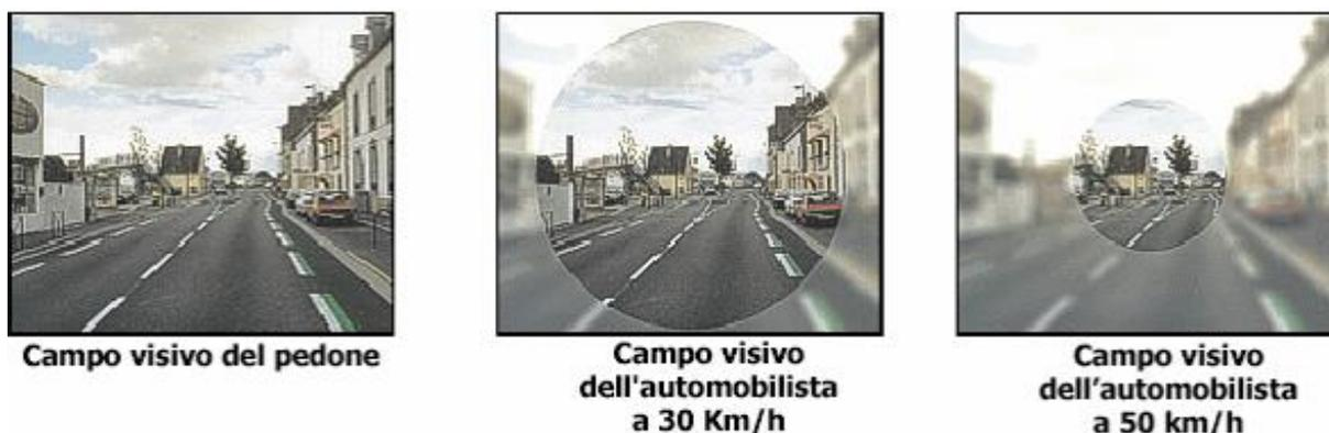
Figura 6-6: Comparazione del campo visivo a differenti velocità
